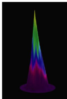
Vista lateral del perfil del haz sin homogeneizador
