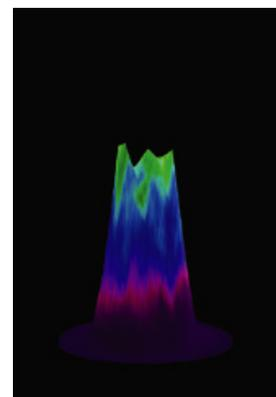
Vista lateral del perfil del haz con un homogeneizador para un haz de "sombrero de copa"
